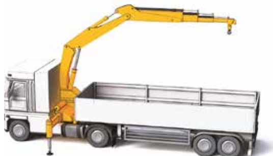
Grue de chargement montée derrière la cabine
