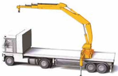
Grue de chargement montée en position centrale
