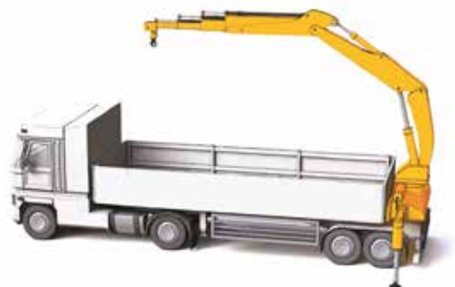
Grue de chargement montée en porte à faux arrière
